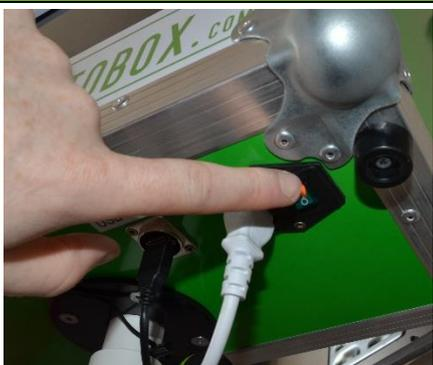
Schalte zunächst die Fotobox auf der Unterseite am Hauptschalter ein (Schalter muss leuchten) und anschließend den Blitz (Ein / Aus Schalter siehe Bild bei Schritt 13). **Hinweis: Das Dauerlicht des Blitzes startet mit ca. 2 Sekunden Verzögerung. Falls nicht, Tipp Nr. 2 auf der Folgeseite beachten.**
