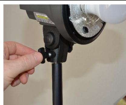
Nimm den Studioblitz aus der Tasche, entferne die Schutzkappe durch ein Drehen entgegen dem UZS (Bajonettverschluss). Achte darauf, dass der blaue Entriegelungsschalter offen ist. Stecke den Blitzflansch auf das Stativ, richte diesen nach vorne aus und ziehe die Schraube handfest an.
