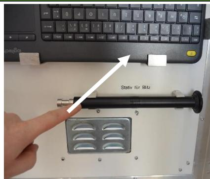
Tastatur aus dem Klappdeckel der Fotobox nehmen, am hinteren Schalter einschalten und mit „Esc“ den Fotobox-Bildschirm verlassen. Dann Programm „Darkroom Booth“ schließen und Windows herunterfahren.
