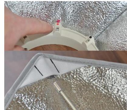
Richte die beiden roten Punkte von Flansch und Alufolie im Inneren miteinander aus. Stecke dann alle 4 Stäbe mit der stumpfen Seite nach außen in die Ecken ein und führe die gegenüberliegenden Enden von seitlich hinter dem Flansch ein (siehe auch Schritt 9).
