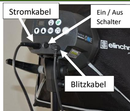
Ziehe dann das Stromkabel durch die obere Öffnung der Fotobox und stecke es in die linke Buchse am Blitzkopf. Als nächstes ziehst du das Blitz-Synchronkabel (Klinke 3,5mm) nach oben und steckst es rechts in die Blitzbuchse.
