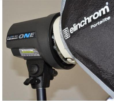
Nehme dann die Softbox und führe den Flansch von vorne in den Studioblitz ein. Achte dabei auf die Ausrichtung: Der „Elinchrom“-Schriftzug der Softbox muss dabei in einer Flucht mit dem Schriftzug des Studioblitzes liegen. Der Flansch muss dann im UZS eingerastet werden.
