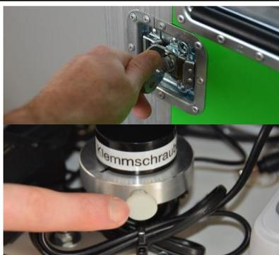
Bild oben: Klappe den Butterfly-Verschluss nach außen, drehe ihn gegen den Uhrzeigersinn und öffne die Fotobox.
