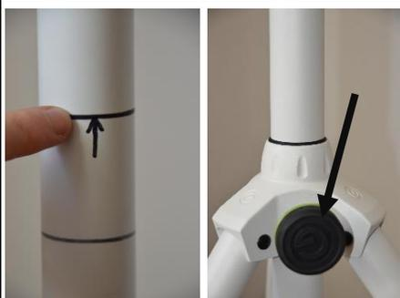
Nimm das Stativ aus der Tasche und fahre es bis zur oberen, mit Pfeil markierter Linie aus. Ziehe die Feststellschraube handfest an.
